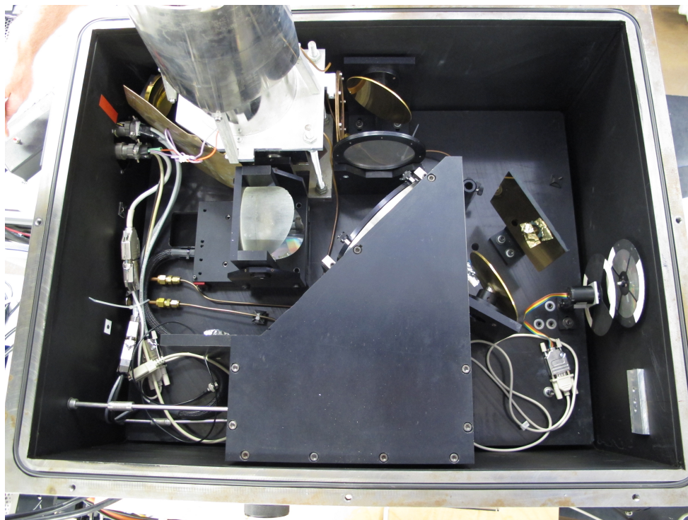
Joonis 2.3: Interferomeeter SPS200. Pildilt on näha valgusallika silindriline ekraan, must polüetüleen-filter, kullatud peeglid, polarisaatorid, kiirtejagaja ning liigutatav peegel.
