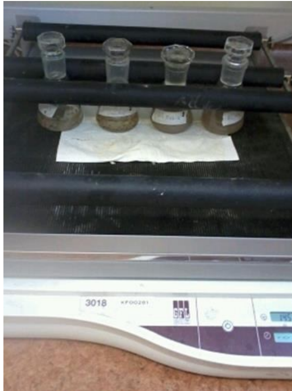
Joonis 9. Tasakaalne adsorptsioonikatse mudellahusega.
