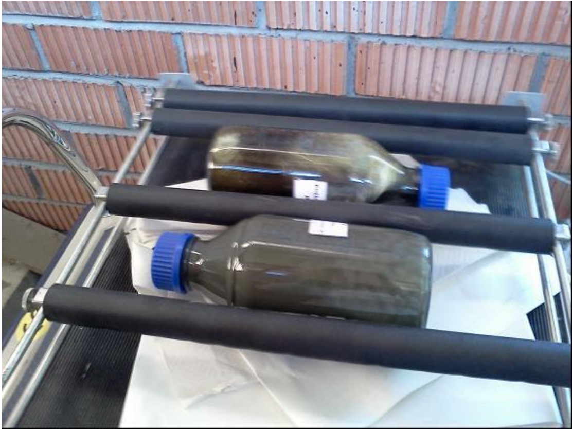
Joonis 14. Fenoolse heitvee adsorptsioonikatse.
