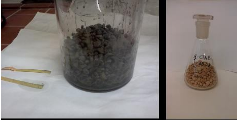
Joonis 15. Adsorbent pärast katset (vasak) ja regenereerimist (parem)
