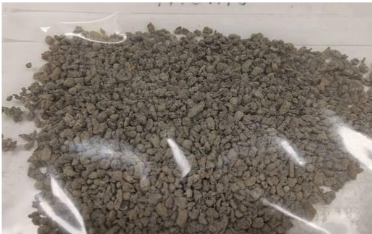
Pilt 10. Reoveesette kääritatud jäägiga granuleeritud põlevkivituha kuivatatud graanulid
