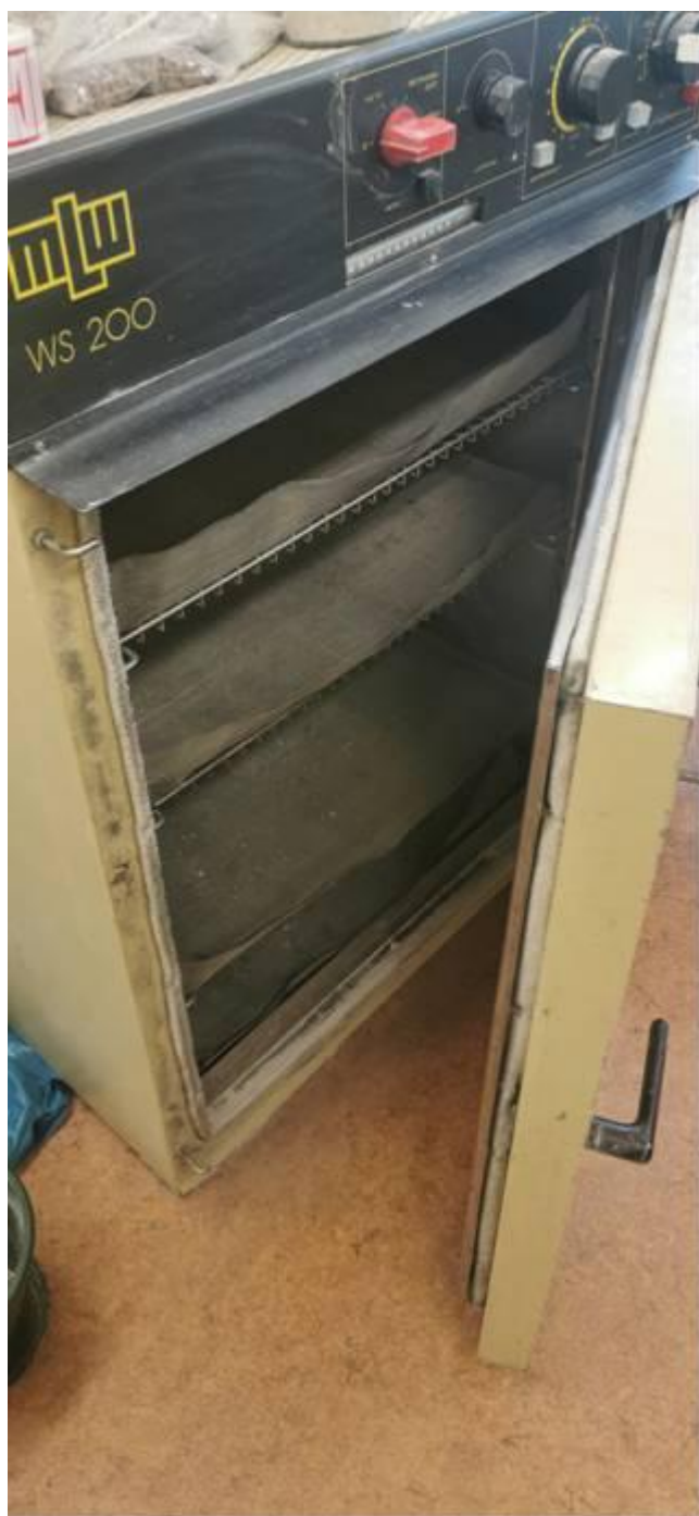
Pilt 9. Reoveesette kääritatud jäägiga granuleeritud põlevkivituha graanulite kuivati
