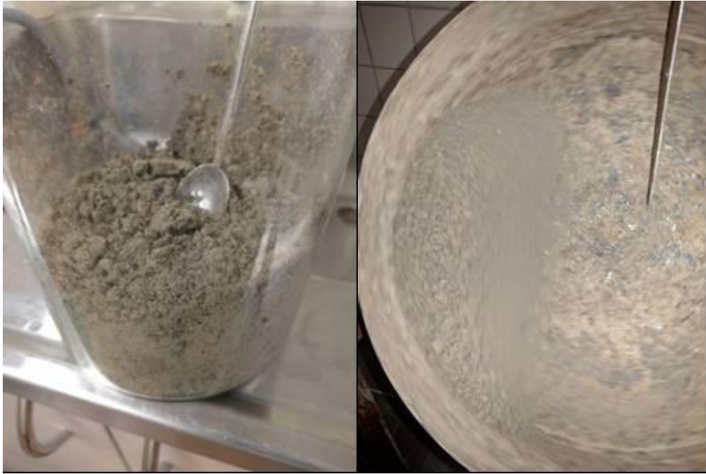
Pilt 8. Põlevkivituha segamine reoveesette kääritatud jäägiga ja granuleerimine
